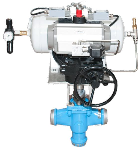
**Konstruktionsmerkmale** AZ-Dreiwege-Kükenhahn mit Anschweißenden, komplett automatisiert. Beispiel eines komplett automatisierten AZ-Kükenhahns mit Handnotgetriebe mit auskuppelbarem Handrad und Zwangsentlüftung, doppelwirkender Antrieb, Reserveluftbehälter mit Sicherheits-, Rückschlag- und Kondensatablassventil, Magnetventil, Filter/Regler und Endschaltern.
