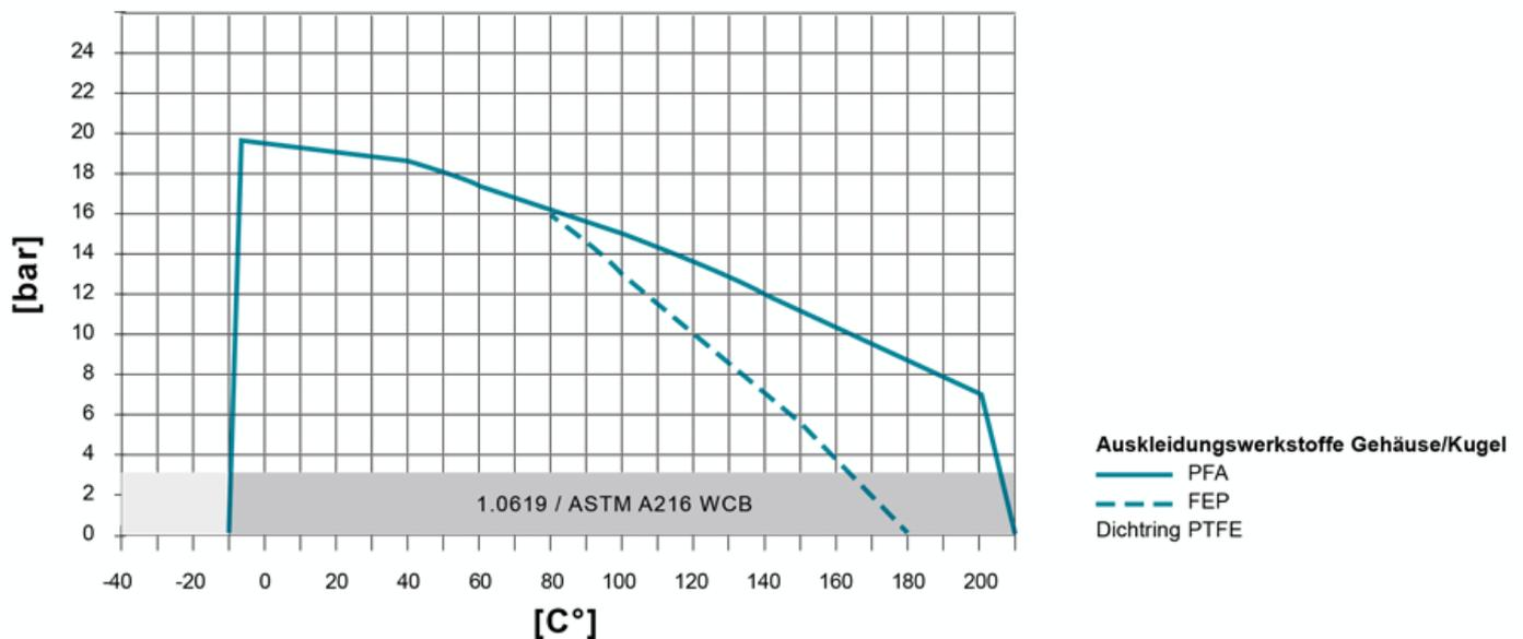
**Einsatztemperaturen  $< -30^{\circ}\text{C}$  und  $> 220^{\circ}\text{C}$  müssen von AZ anhand der Betriebsbedingungen geprüft und bestätigt werden.**
