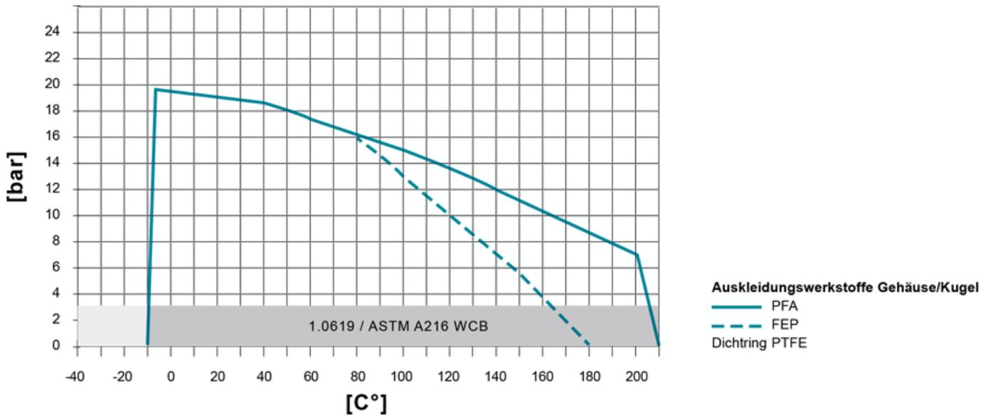
Los valores especificados dependen de la aplicación respectiva (medio). Temperaturas de funcionamiento inferiores a -20 ° C solo con material del cuerpo 1.4408 o acero a baja temperatura. Alta resistencia a la presión / resistencia a la temperatura bajo pedido, Ej. PN 40.
